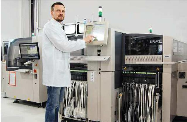
**Erhöhte Kapazität:** Mit dem im vergangenen Jahr beschafften Bestückungssystem Siplace X2 können Produkte mit über 150 Bauteilen verschiedener Typen auf der Linie bestückt werden. Bis zu drei Leiterplatten lassen sich dabei parallel bestücken.
