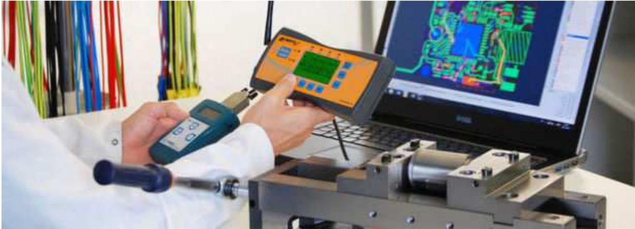
Die mobile Empfangseinheit des Allmatic Clamp Assist erlaubt die sichere Fernsteuerung der Schubkraft von Schraubstöcken in einem Umkreis bis zu 20 Metern. (Bild: Tecnotron)
